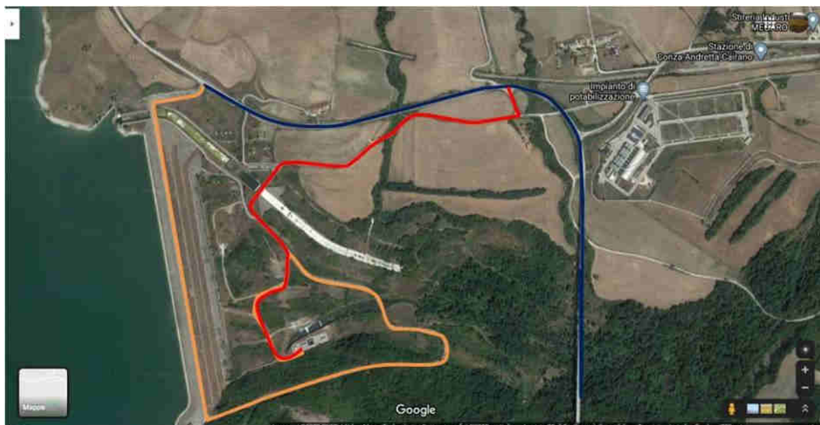
Figura 59 - Alternative di viabilità di accesso al cantiere.
