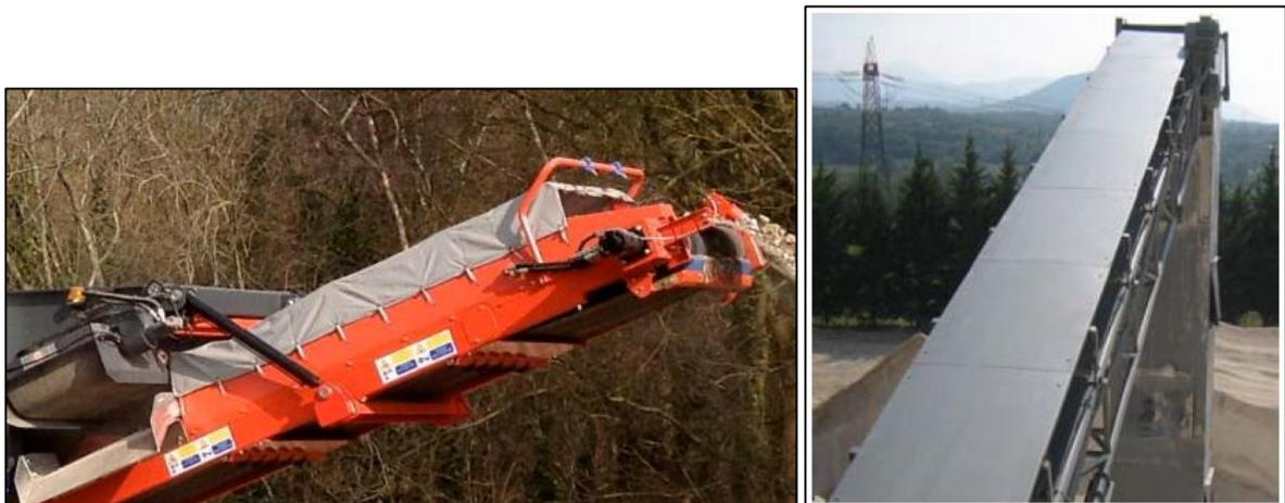
**Figura 36** – Esempio di installazione di cupolini / copertura antipolvere applicati su nastro trasportatore.
