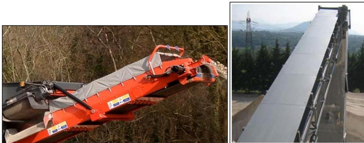
**Figura 28** – Esempio di installazione di cupolini / copertura antipolvere applicati su nastro trasportatore.
