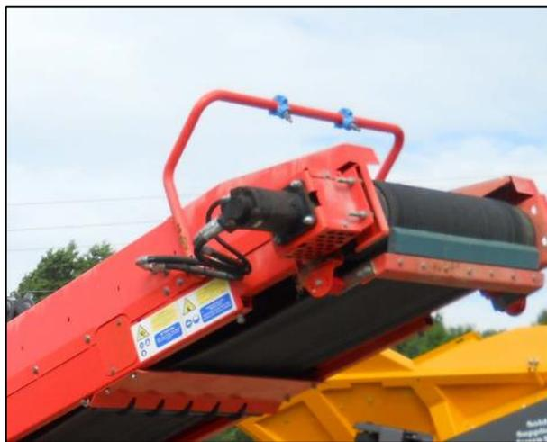
Figura 35 – Esempio di installazione del gruppo di nebulizzazione sui nastri trasportatori.
