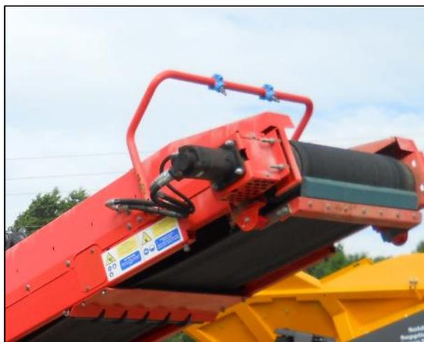
Figura 27 – Esempio di installazione del gruppo di nebulizzazione sui nastri trasportatori.
