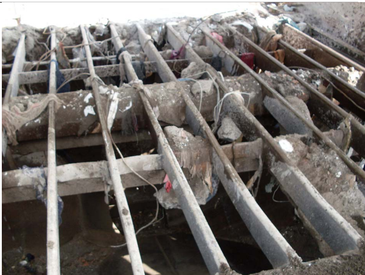
Figura 6 – Particolare della superficie a maglie della tramoggia e della sottostante vasca di raccolta e immissione ai mulini triturator
