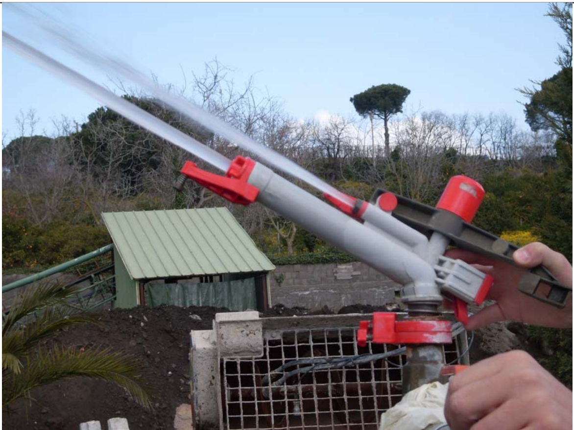
Figura 13 – Particolare degli aspersioni ad alta pressione utilizzati per la bagnatura dei cumuli di inerti
