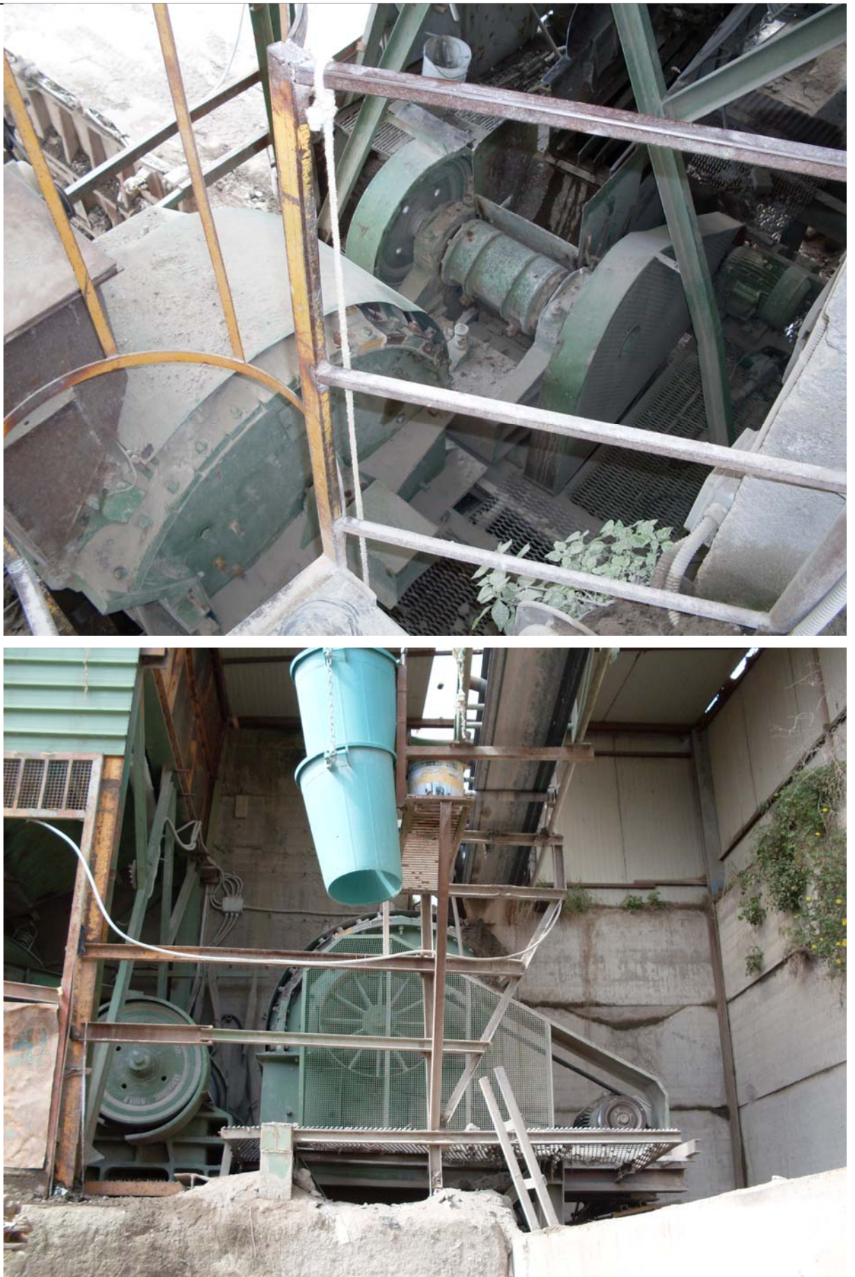
Figura 7 – Particolare dei due mulini trituratorii utilizzati dalla ditta
