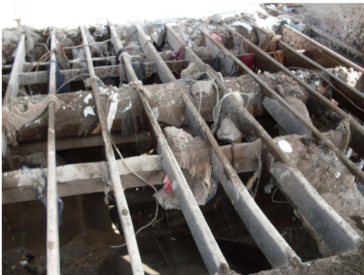
Figura 6 – Particolare della superficie a maglie della tramoggia e della sottostante vasca di raccolta e immissione ai mulini trituratorini
