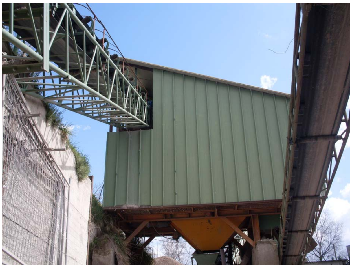
Figura 8 – Particolare dei nastri trasportatori e del sistema di vagliatura
