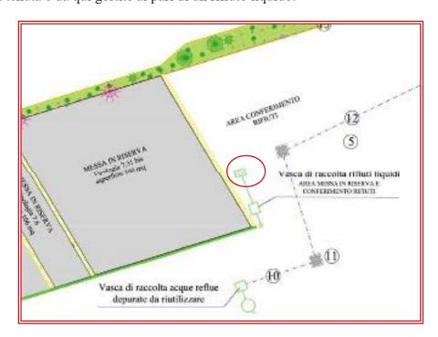
Figura 21-Sistema di collettamento delle acque reflue- Area conferimento rifiuti inerti-
