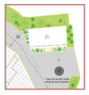
Figura 19-Sistema di collettamento delle acque reflue domestiche
