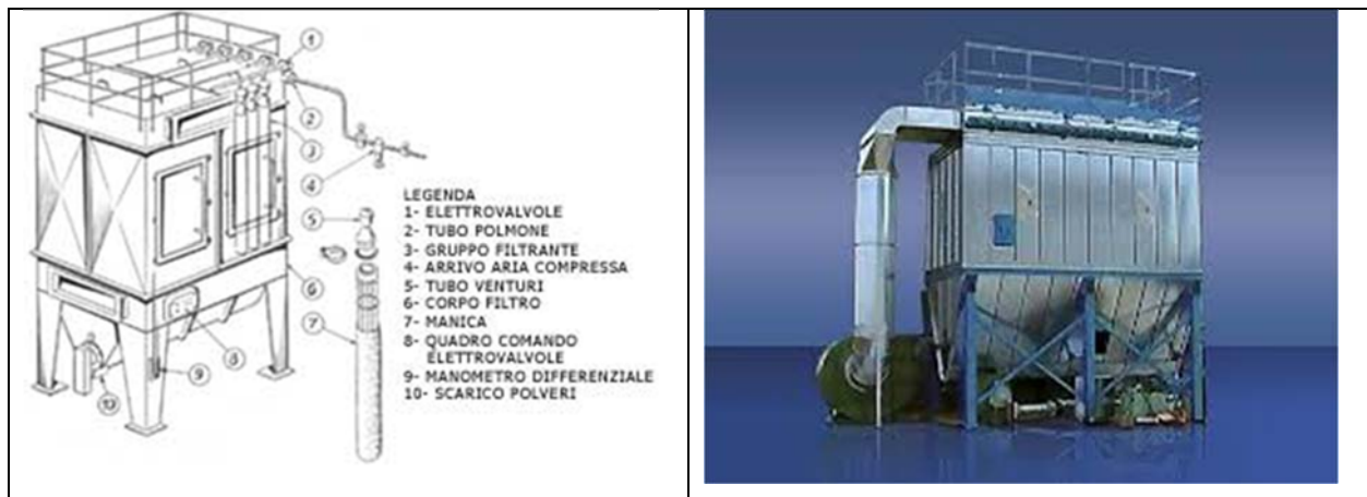
Figura 75. Schema e foto di un filtro a maniche del tipo da installare in impianto
