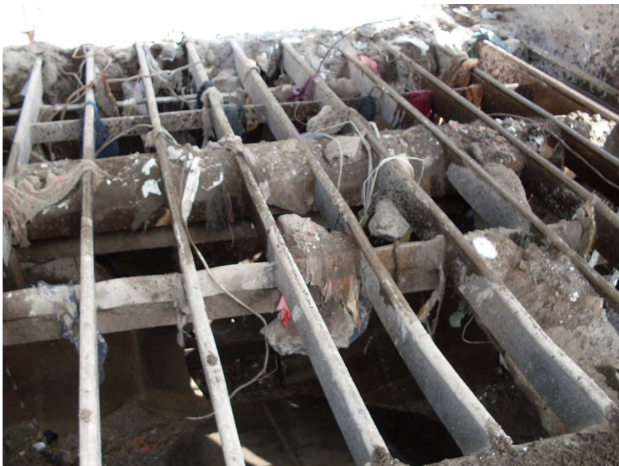
Figura 6 – Particolare della superficie a maglie della tramoggia e della sottostante vasca di raccolta e immissione ai mulini trituratori
