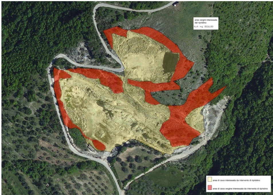
Figura 3: area di lavorazione. In rosso, le aree vergini interessate dalla soluzione con gradoni 5x5 m.
