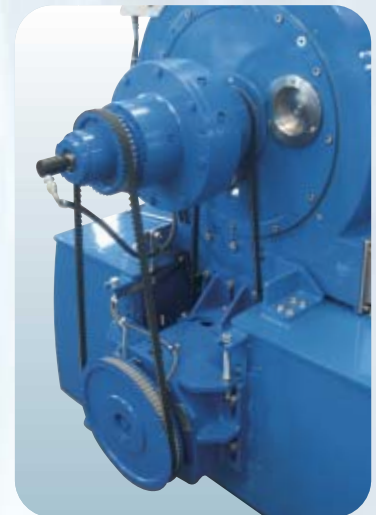
Particolare Rotovariatore e riduttore Detail of Rotovariator and reduction gear
