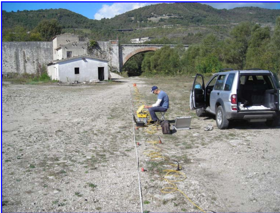
Fig. 1 – Prospezione sismica MASW effettuata in area progettuale.
