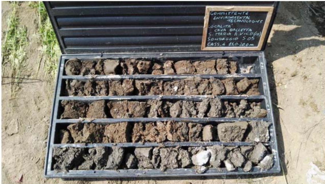
Figura 9. Carote estratte dal sondaggio S05 (profondità 15.0-20.0 m) e disposte in cassetta catalogatrice.
