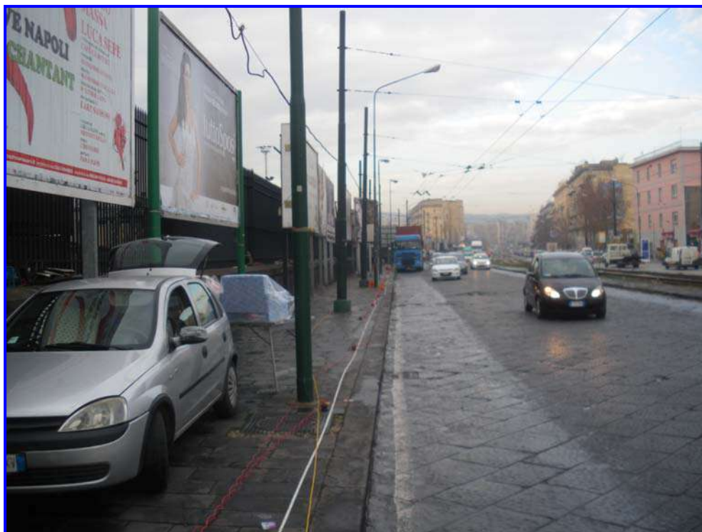
Fig. 1 – Stendimento multielettrodo n.1 effettuato in Via Reggia Di Portici nel territorio comunale di Napoli (NA). Tomografia geoelettrica A-B. 64 elettrodi di misura, spaziatura elettrodoica 5m. Lunghezza complessiva stendimento 315m.
