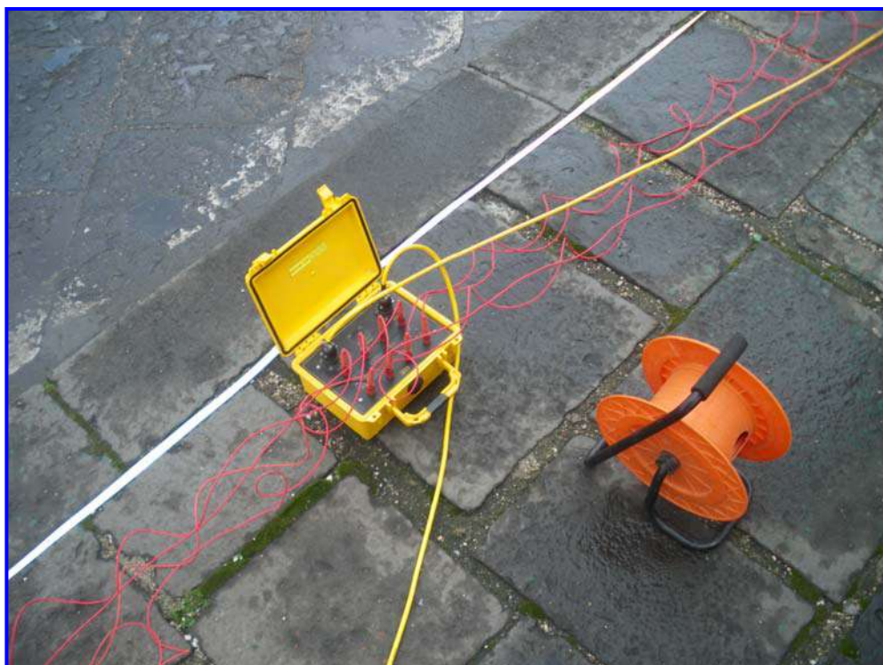
Fig. 6 – Stendimento multielettrodo n.6 effettuato alla Via Parrillo nel territorio comunale di Napoli (NA). Tomografia geoelettrica M-N. 64 elettrodi di misura, spaziatura elettrodoica 5m. Lunghezza complessiva stendimento 315m.
