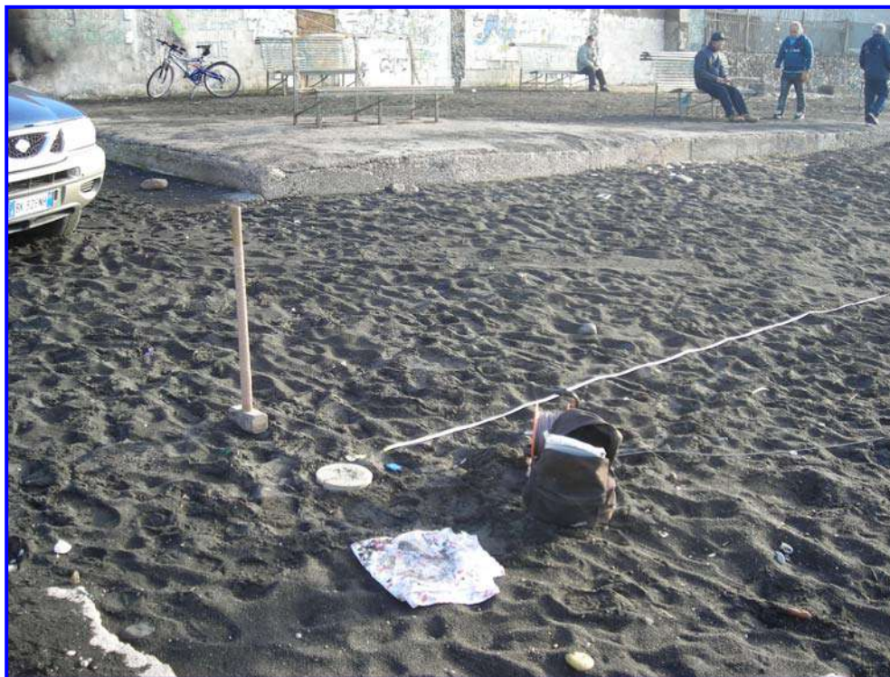
fig.16– Sorgente energizzante, costituita da massa battente di 10kg su piastra di alluminio. Come starter/trigger è stato utilizzato un geofono verticale Geospace a 14Hz.
