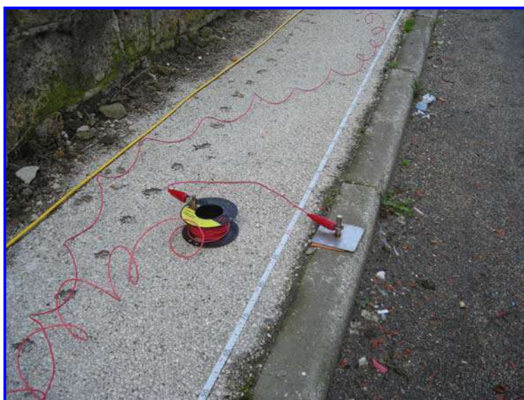
Fig. 9 – Elettrodo costituito da picchetto in acciaio inox ed elettrodo speciale in acciaio inox costituito da piastra quadrata poggiata sulla pavimentazione utilizzati per le indagini geoelettriche multielettrodo effettuate.
