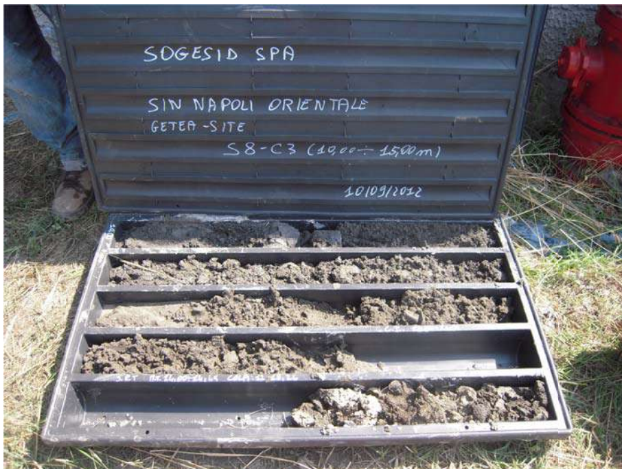
Foto n.4: Cassetta catalogatrice sondaggio S8: 10.0 – 15.0 m
