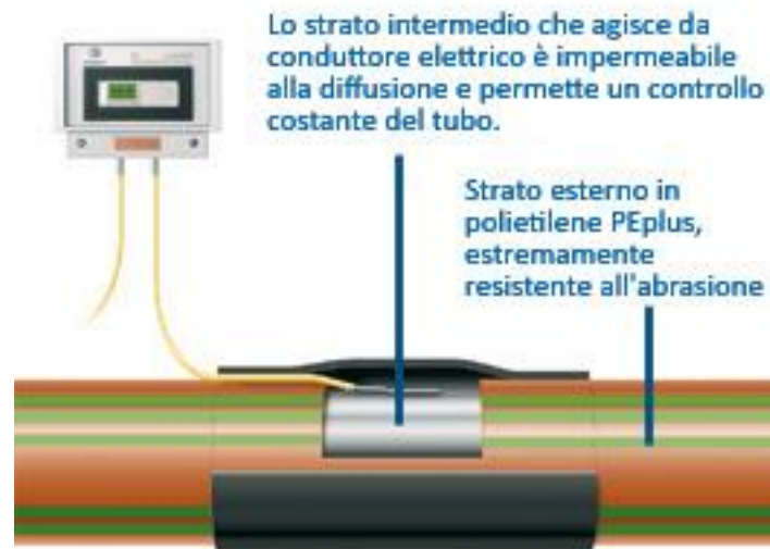
Figura 2.17 – Tubazioni dotate di sistema automatico di rilevamento perdite.
