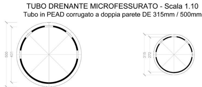
Figura 2.14 - Tubazioni microfessurate drenanti
