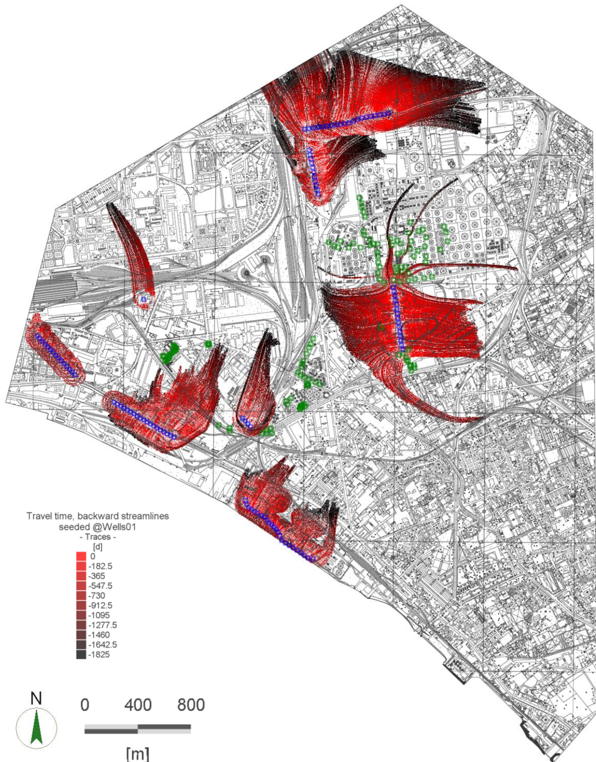
Figura 110 - Efficienza idraulica degli interventi: area di influenza e cattura dei pozzi di MiSPT (Layer 2).
