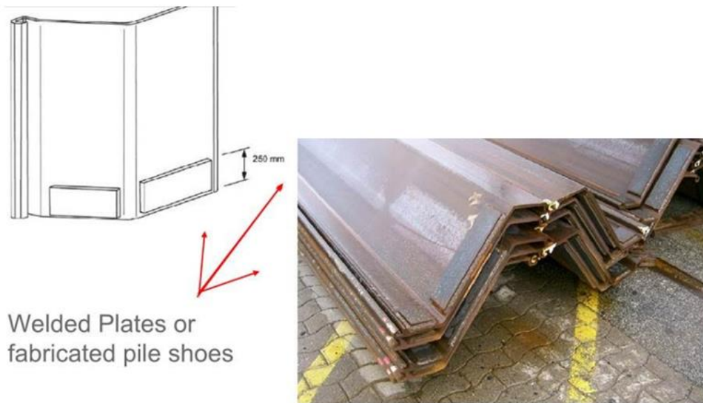
Figura 5.7 – piatti di rinforzo saldati al piede delle palancole per facilitarne l’infissione.
