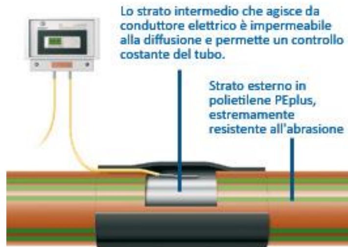
Figura 5.9 Tubazioni dotate di sistema di rilevamento in continuo delle eventuali perdite
