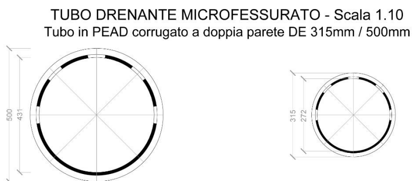
Figura 5.4 - Tubazioni microfessurate drenanti
