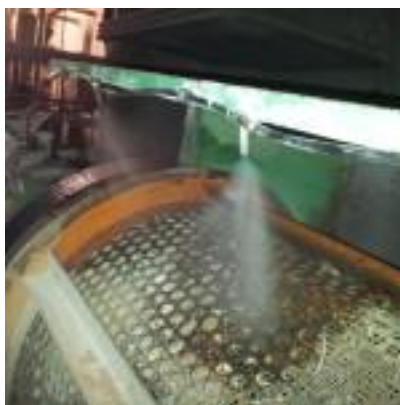
Figura 8 – Es. di sistema di nebulizzazione su centrifuga
