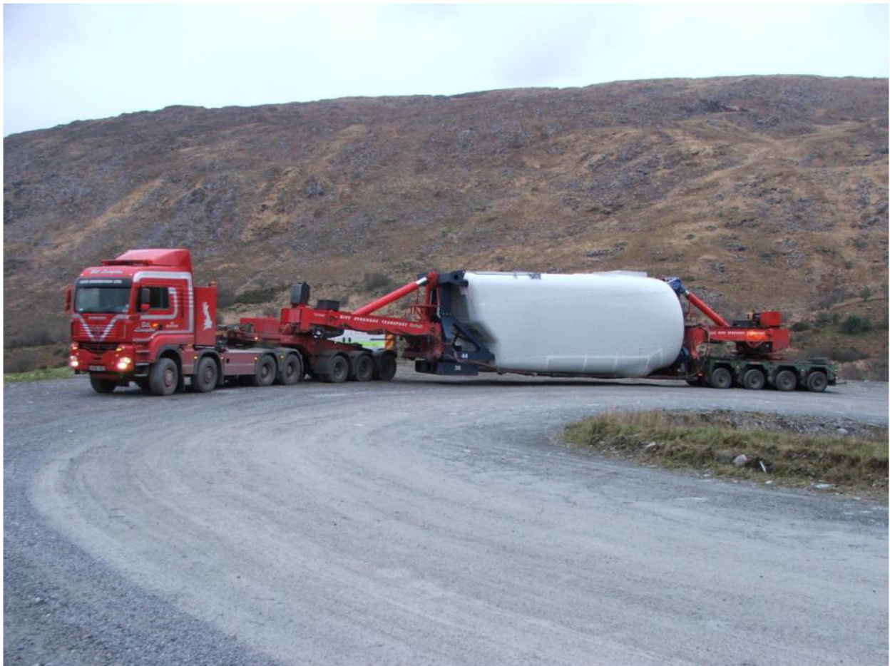
Esempio di trasporto della navicella nella viabilità interna ad un parco eolico
