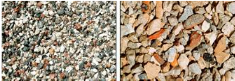
Frazione fine (0-5 mm) e frazione grossa (5-15 mm) di aggregato riciclato da macerie di demolizione
