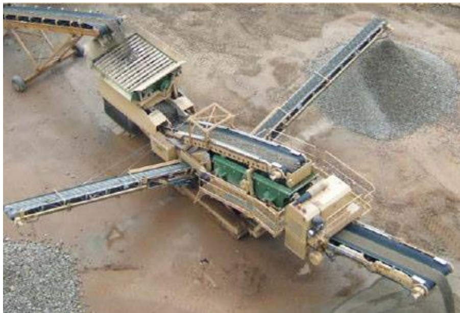
Impianto di frantumazione
