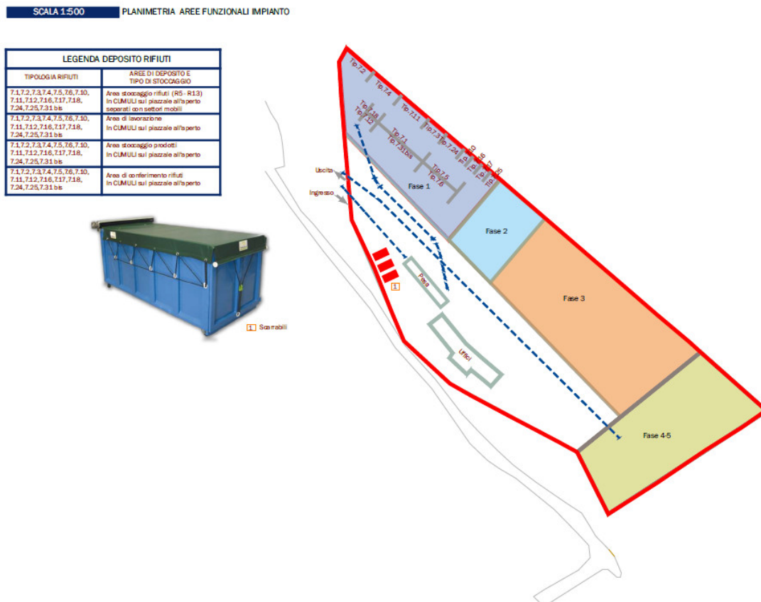
Figura 12: Suddivisione dell'Impianto in aree funzionali.
