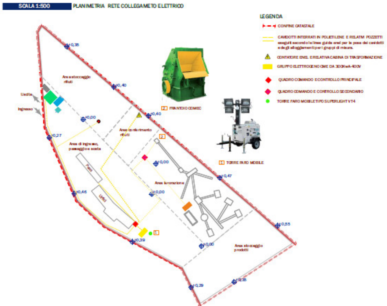
Figura 16: Schema rete elettrica dell'impianto.
