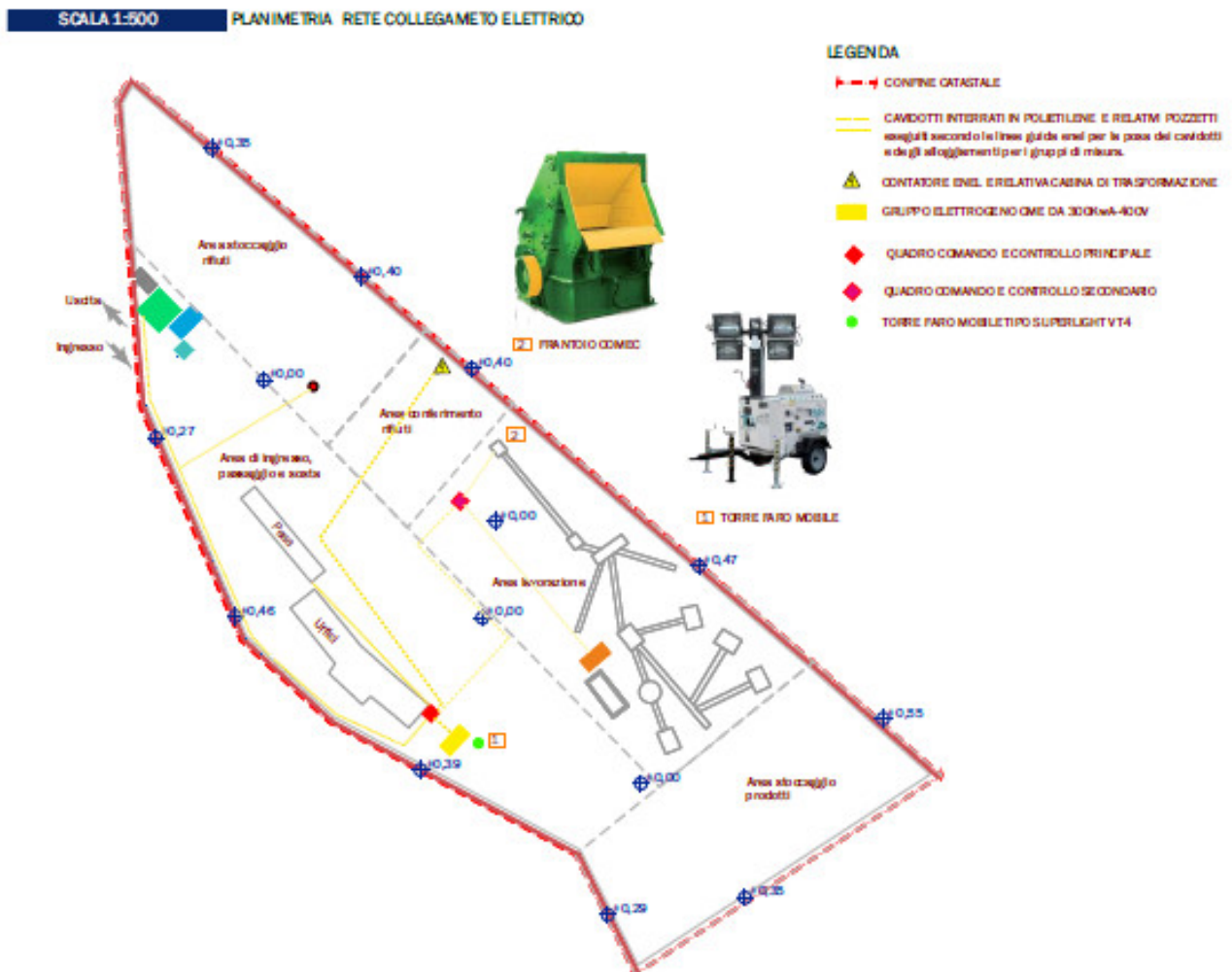
Figura 6: Schema rete elettrica dell'impianto.
