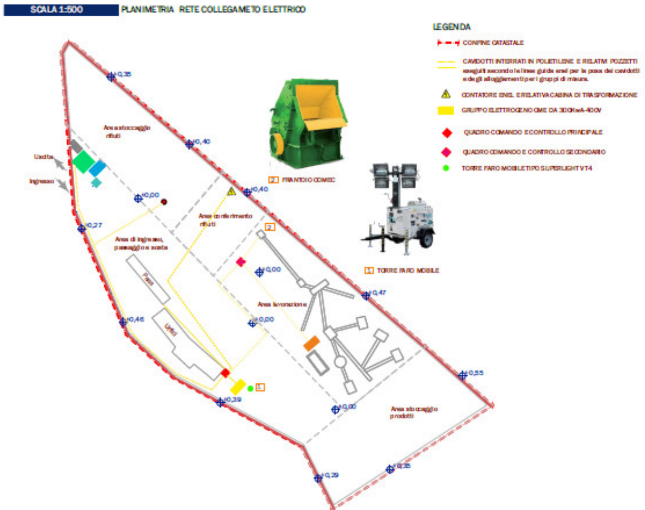
Figura 55: Schema rete elettrica dell'impianto.
