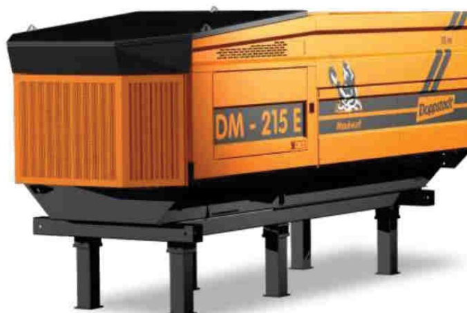
Figura 9 - Miscelatore del verde strutturante e della frazione solida in uscita dai fermentatori
