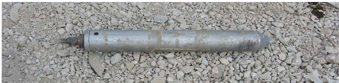
Campionatore nella posizione di infissione a pressione
